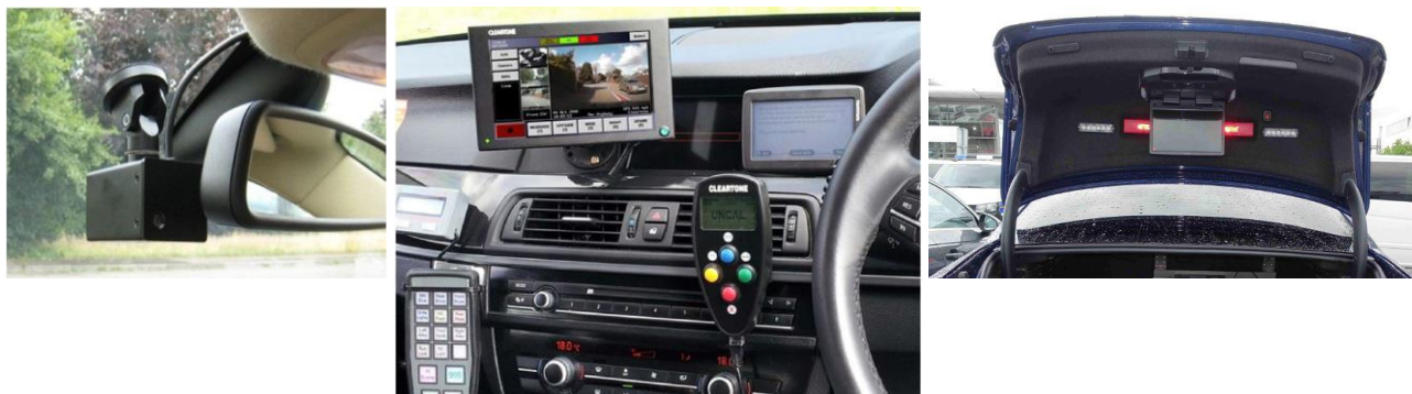
Slika 3. Položaj komponenti: kamera - Cam2CP, SE6/1, upravljački zaslon u kabini vozila MD7RC i preklopni zaslon za prekršitelja ugrađen u prtljažnik vozila
